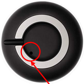
1. ทำการกดปุ่ม Code ค้างไว้ 6วินาทีจนมีไฟสีน้ำเงินกระพริบต่อเนื่อง (แบบไว)
